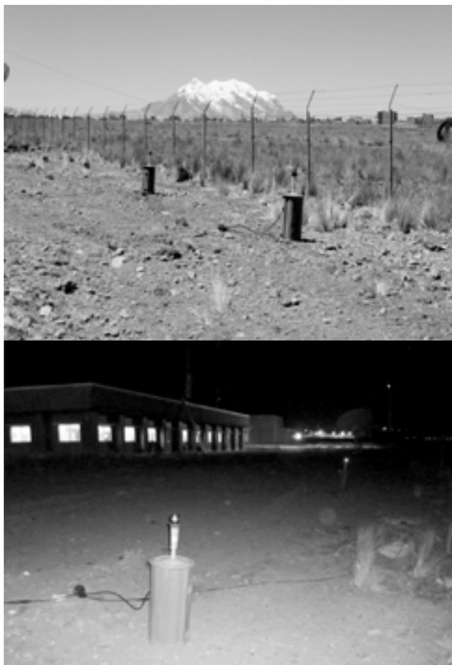
**Fig. 3** Luminarias ETES de marca ADB con lámparas LED en pruebas Aeropuerto El Alto
