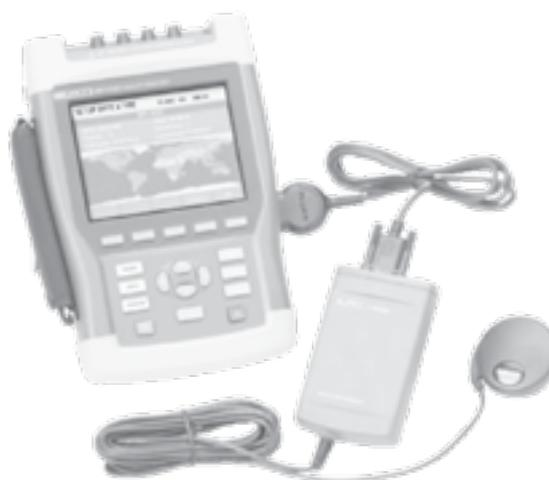
*Analizador de Calidad Eléctrica Fluke 435 con sincronización por hora GPS*
