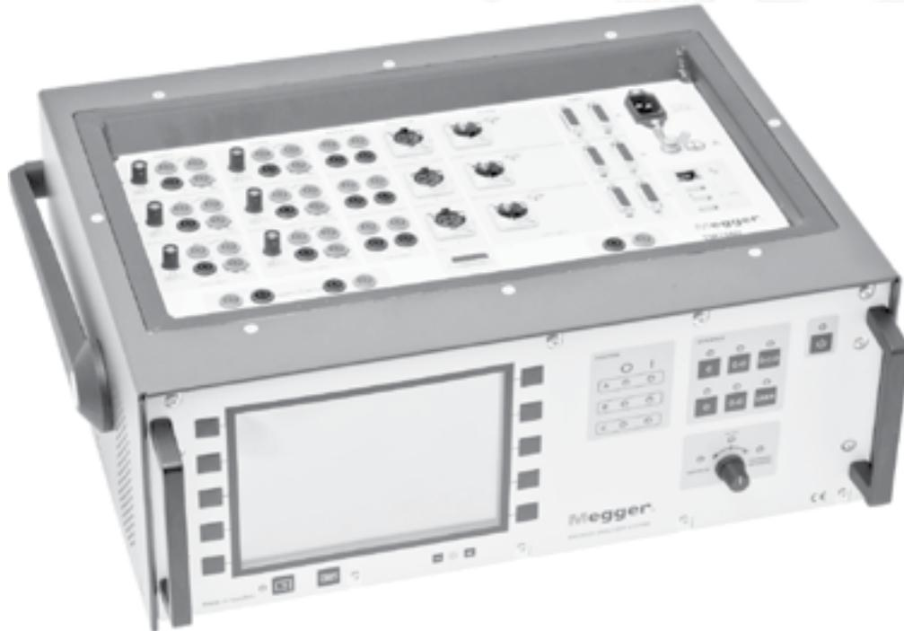
tierra monofásica. Las unidades de control también permiten medir automáticamente el voltaje de control, en línea con IEC 62271-100, y medir la corriente de bobina en cada fase por separado. Vale notar que muchos instrumentos más antiguos miden solamente la corriente total para las tres fases. Desafortunadamente, esta medición es esencialmente inútil.
