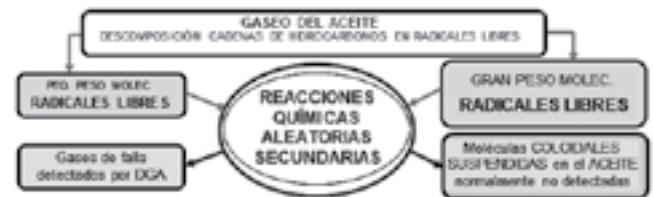
**Figura 1.** Esquema de Gaseo del Aceite
