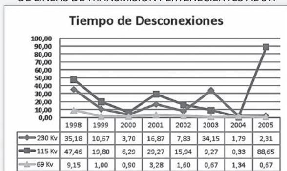
En el Gráfico 2.2 se observa un decremento del tiempo promedio de las desconexiones para las líneas en los tres niveles de voltaje. Sin embargo se observa en los últimos años un fuerte incremento de este índice en las líneas de 115 kV y 230 kV, debido a la ocurrencia de una falla en la línea de transmisión San José - Vinto que tuvo una duración de 199.31 minutos, registrada en fecha 18 de julio de 2003 que ocasionó el colapso de todo el SIN.
