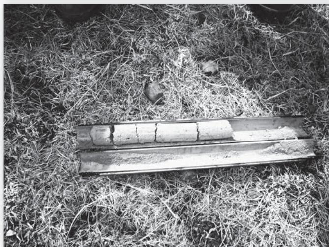
Previa a la elección final se realizó el Estudio de suelo, para determinar la dureza del terreno así determinar las dimensiones y proporcionar las zapatas, columnas y el área de la caseta.
