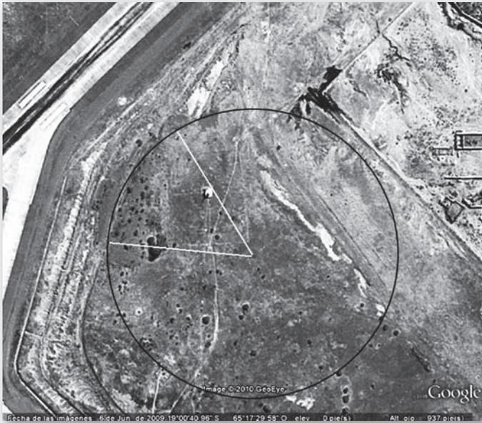
Para el VOR convencional es necesario clarear un terreno adicional hasta completar un radio total libre de obstáculos de 400 metros mientras que para el VOR Doppler es suficiente con el radio de 200 metros.
